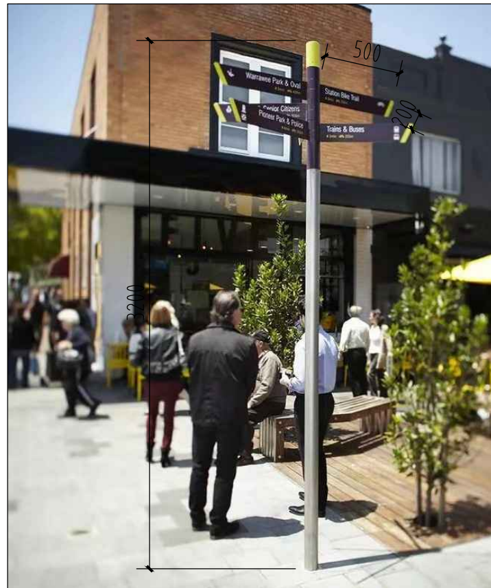
注: H=3.2\text{m} , 不锈钢管+不锈钢板
